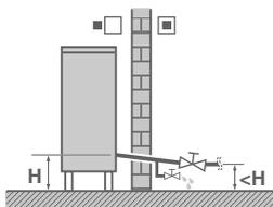
När det finns vatten i systemet är det sannolikt att det fryser, vilket kan leda till skada på systemet.
