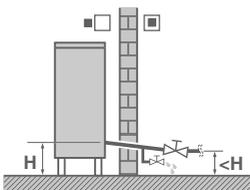
Kun laitteen sisällä oleva vesi ei ole liikkeessä, se saattaa jäätyä ja vaurioittaa laitetta.
