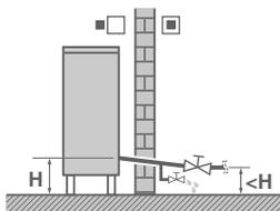
Når vannet inne i systemet står i ro er det stor sannsynlighet for at det kan fryse, noe som kan gjøre skade på systemet.
