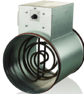
Kanavalämmitin 0.6 kW - 2.4 kW lämmitysteholla ja integroidulla elektronisella termostaatilla
