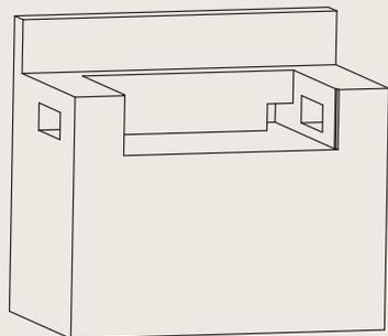
Um den Imperatore perfekt in Ihre Außenküche einbauen zu können, müssen Sie unbedingt die folgenden Maße (in mm) beachten. Vergewissern Sie sich, dass auf der rechten und linken Seite des Geräts eine Öffnung für die Belüftung vorhanden ist. Außerdem muss auf der Rückseite des Geräts Platz für den Elektroanschluss (links) und den Gasanschluss (rechts) vorgesehen werden.
