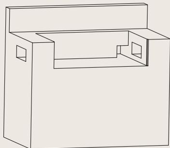
Alla olevia mittoja (mm) noudattamalla Imperatore-grilli voidaan liittää täydellisesti omaan ulkokeittiöön. Varmista, että laitteen oikealla ja vasemmalla puolella on ilmanvaihtoaukko. Lisäksi tilaa on varattava laitteen takapuolella olevaa sähköliitintää (vasemmalla) ja kaasuliitintää (oikealla) varten.
