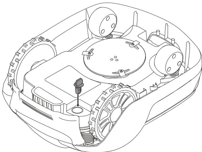
Поместите ключ безопасности в замок под газонокосилкой и поверните в положение **Включено**.
