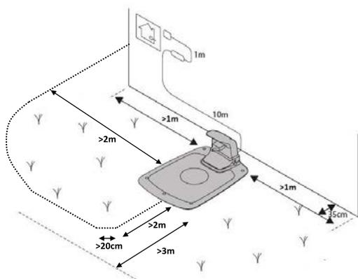
Lasciare quanto più spazio possibile a sinistra del cavo guida (stando di fronte alla stazione di carica).
