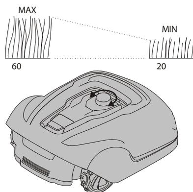
I de første par uger sættes klippehøjden til 60 mm for at undgå at klippe i afgrænsningskablet og styrekablet. Sænk indstillingen af klippehøjden et trin i de følgende uger, indtil den ønskede klippehøjde er nået.
