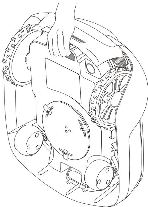
Appuyez sur le bouton **STOP** et retirez la clé de sécurité avant le levage.
