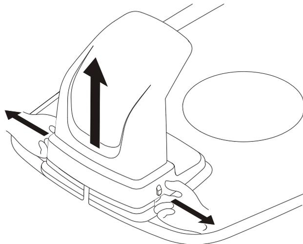
Отстранете предпазния капак на зарядното устройство чрез натискане на пластините от всяка страна на основата и снемете капака.
