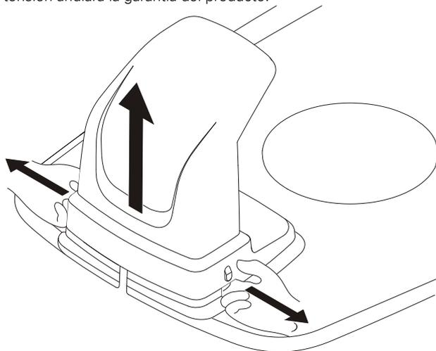
Retire la cubierta protectora de la estación de carga presionando las solapas a cada lado de la base y levantando la cubierta.
