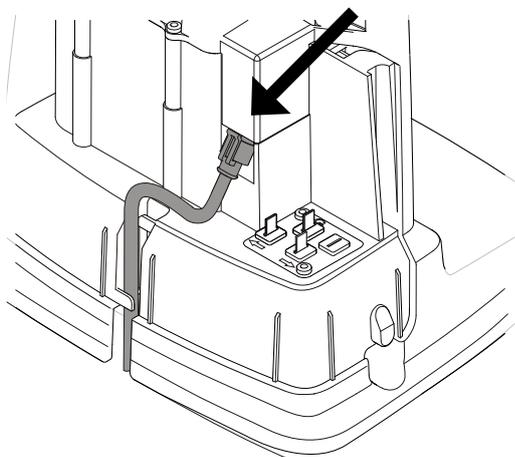
Csatlakoztassa a kisfeszültségű kábelt a töltőállomáshoz.
