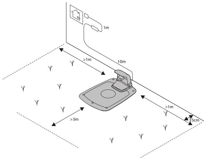
Coloque la estación de carga de la siguiente manera:
