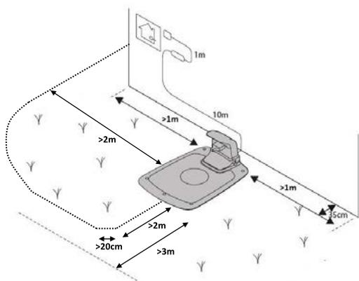
Før styrekablet hen til sløjfen på afgrænsningskablet, hvor styrekablet skal tilsluttes.
