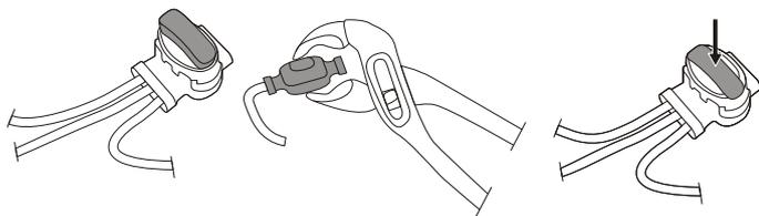
Vložte oba konce ohraničujícího drátu a konec vodičího drátu do spoje a spojky vodičího drátu. Zkontrolujte, zda jsou dráty plně zasunuty do spoje a spojky vodičího drátu tak, aby byly konce přes spoj a spojku vodičího drátu viditelné.
