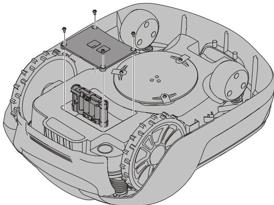
**OPOZORILO! Pritisnite gumb STOP (USTAVI) in odstranite varnostni ključ, preden zamenjate baterije. Pri tem nosite zaščitne rokavice.**
