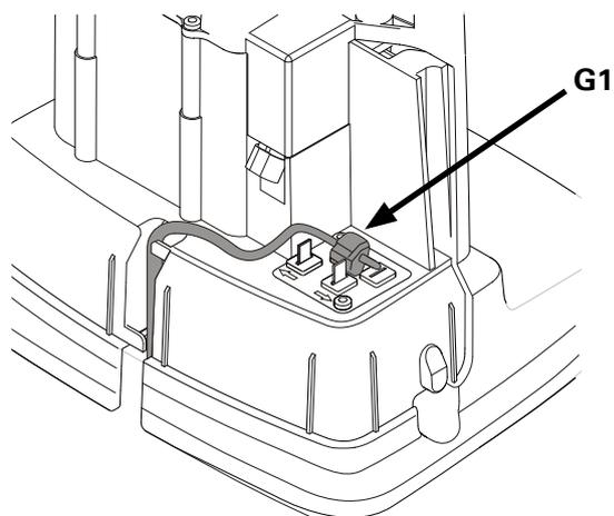
Conectați firul de ghidare la stația de încărcare după cum urmează:
