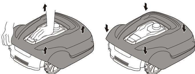
Apăsați robotul cu o mână și ridicați cu fermitate unul dintre colțurile caroseriei și repetați procedura pentru toate colțurile, până când corpul este detașat de șasiu.
