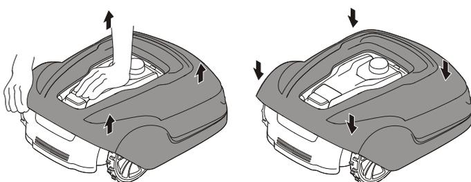
Håll ned klipparen med en hand och lyft ordentligt i ett av karossens hörn. Upprepa detta i samtliga fyra hörn tills karossens lossar från chassit.
