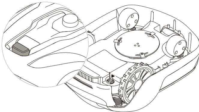
Drücken Sie die **STOP**-Taste am Mäher und ziehen Sie den Sicherheitsschlüssel ab.
