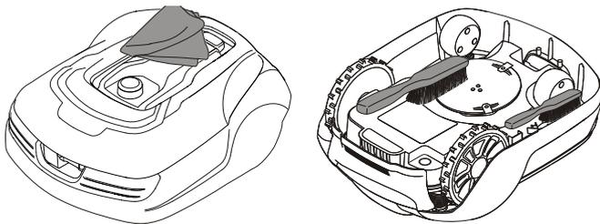
**OPOZORILO!** Pritisnite gumb STOP (USTAVI) in pred čiščenjem odstranite varnostni ključ.
