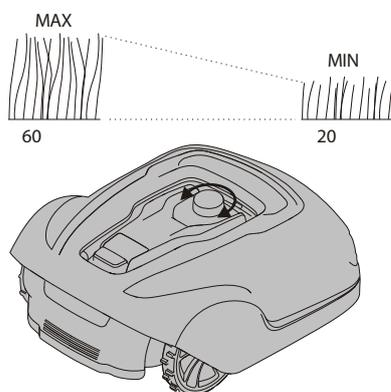
Ställ för de första veckornas klippning in klipphöjden på 60 mm för att se till att begränsningskabeln och guidekabeln inte klipps. Sänk därefter inställningen ett steg varje vecka tills den önskade klipphöjden nås.
