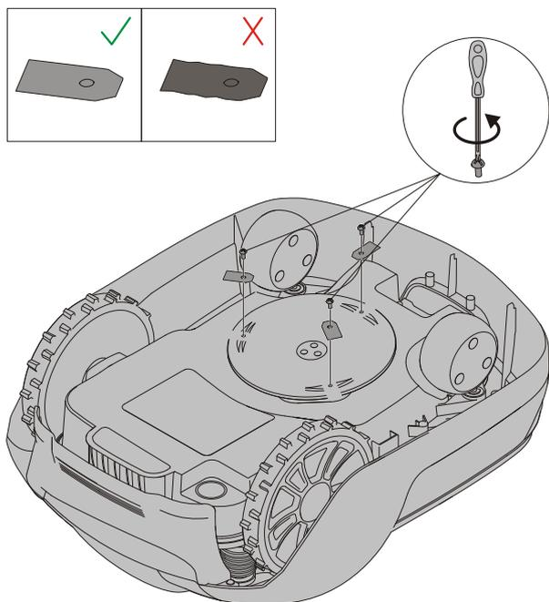
**WARNING! Tryck på STOPP-knappen och ta ur säkerhetsnyckeln innan du byter ut knivarna. Använd skyddshandskar.**
