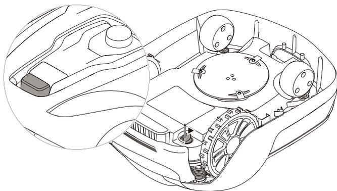
Stiskněte tlačítko **STOP** umístěné na sekačce a vyjměte bezpečnostní klíč.
