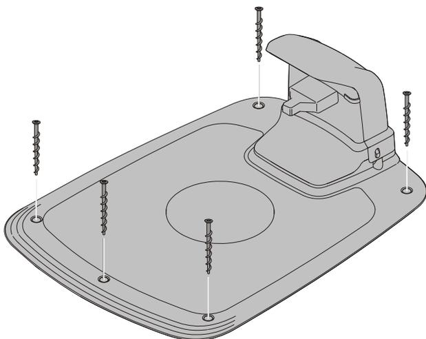
Fixați stația de încărcare de sol utilizând cele cinci șuruburi de fixare incluse cu ajutorul unei chei hexagonale de 6mm.
