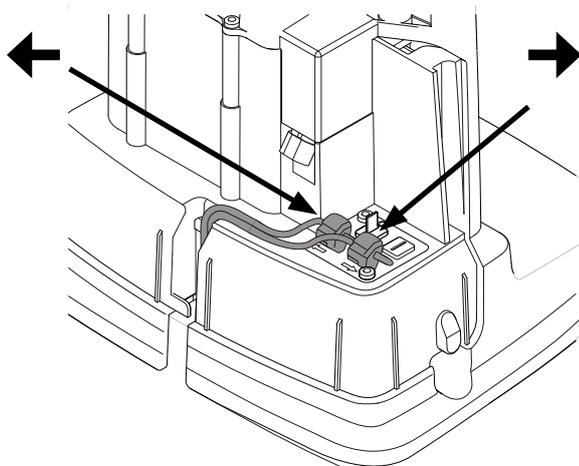
Przewód graniczny należy podłączyć do stacji ładowania w następujący sposób:
