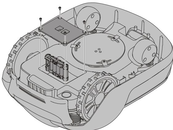
**AVERTISSEMENT ! Appuyez sur le bouton STOP et retirez la clé de sécurité avant le remplacement des batteries, sans oublier de porter des gants de protection.**
