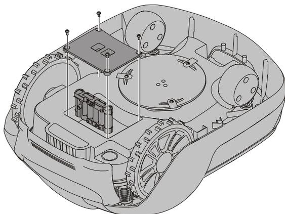
**AVVERTENZA!** Premere il tasto di **ARRESTO** e rimuovere la chiave di sicurezza prima di sostituire la batteria; indossare guanti protettivi.
