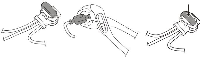
Stecken Sie beide Enden des Begrenzungsdrahts sowie das Ende des Führungsdrahtes in den Spleiß- und Führungsdrahtverbinder. Überprüfen Sie, ob die Drähte vollständig in den Spleiß- und Führungsdrahtverbinder eingeführt sind, so dass die Enden durch den Spleiß- und Führungsdrahtverbinder sichtbar sind.
