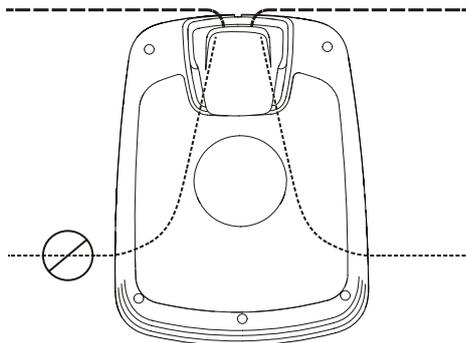
Toda la estación de carga debe estar dentro de la superficie de trabajo , como viene indicado en la ilustración.
