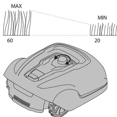
În primele săptămâni de tuns, setați înălțimea de tăiere la 60mm pentru a evita tăierea firului de delimitare și a firului de ghidare. Coborâți înălțimea cu un nivel în fiecare săptămână după aceasta până când înălțimea de tăiere dorită este obținută.
