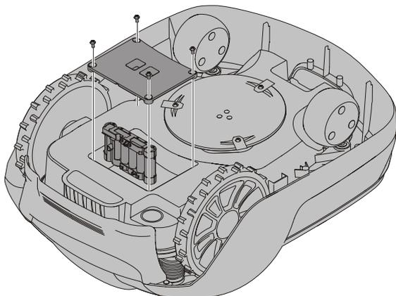
**OSTRZEŻENIE!** Przed wymianą akumulatora należy nacisnąć przycisk STOP i wyjąć kluczyk zabezpieczający; w czasie wymiany należy mieć założone rękawice ochronne.
