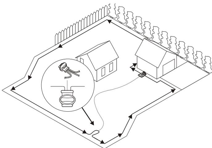
Il tosaerba utilizza il cavo guida facoltativo per individuare il percorso di ritorno verso la stazione di ricarica, ma anche per individuare le aree più difficili da raggiungere. Ad esempio, il cavo guida viene steso tra la stazione di ricarica e un punto lontano dell'area di lavoro oppure in un passaggio stretto.
