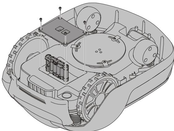
**AVERTISMENT! Apăsați butonul STOP și îndepărtați cheia de siguranță înainte de a înlocui bateriile și purtați mănuși de protecție.**
