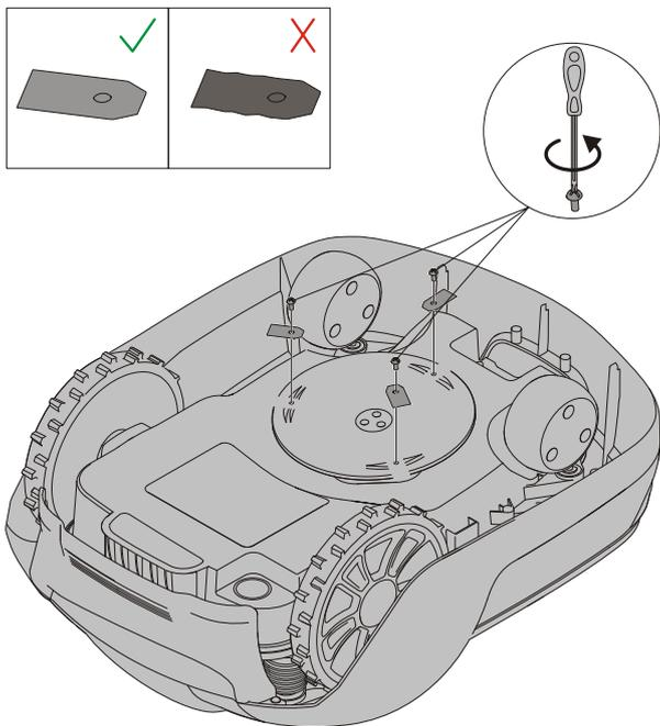
**WARNUNG!** Drücken Sie die STOP-Taste und ziehen Sie den Sicherheitsschlüssel ab, bevor Sie die Messer austauschen. Tragen Sie dabei Schutzhandschuhe.
