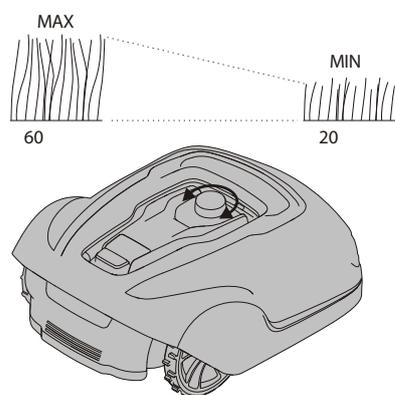
Během prvních několika týdnů sekání nastavte výšku sekání na 60 mm, aby nedošlo k přeřezání ohraničujícího drátu a vodícího drátu. Poté každý týden snižte nastavení o jeden krok, až dosáhnete požadované výšky sekání.
