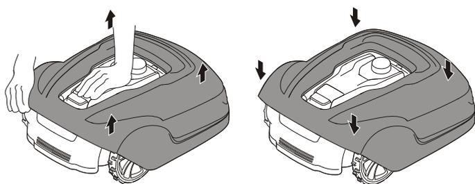
Sujete el cortacésped con una mano y levántelo firmemente por una de las esquinas de la carrocería y repita para las cuatro esquinas, hasta que el la carrocería se suelte de la carcasa.
