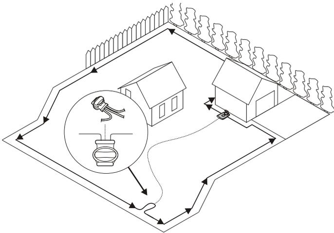
Для газонокосилки может использоваться дополнительный направляющий провод, чтобы она могла добраться до зарядной станции и труднодоступных рабочих участков. Направляющий провод укладывается между зарядной станцией и труднодоступным участком, например, для преодоления машиной узкого прохода.
