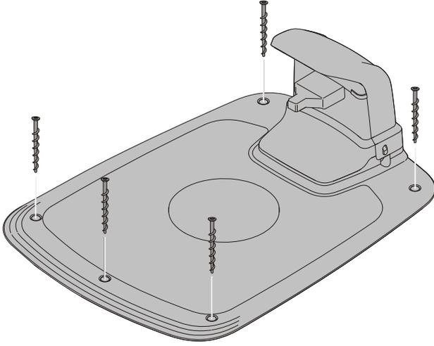
Kiinnitä latausasema maahan käyttäen viittä mukana toimitettua kiinnitysruuvia ja 6 mm:n kuusiokoloavainta.
