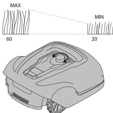
Sett klippehøyden til 60 mm de første ukene med gressklipping for å unngå å kutte grense- og ledkabelen. Senk innstillingen ett trinn hver uke etter dette til du har nådd ønsket klippehøyde.
