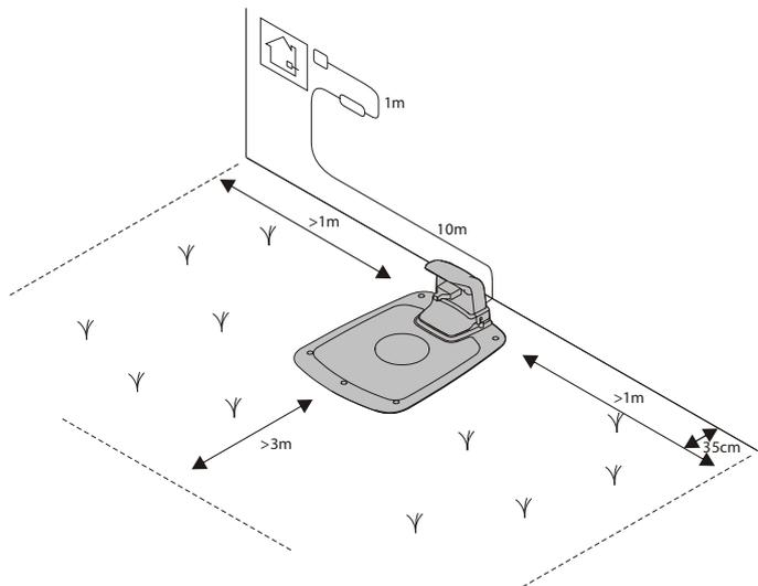
Stację ładowania należy ustawić w następujący sposób:
