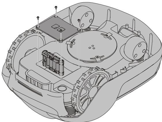
**¡ADVERTENCIA! Pulse el botón de PARADA y retire la llave de seguridad antes de sustituir las baterías y lleve guantes de protección.**
