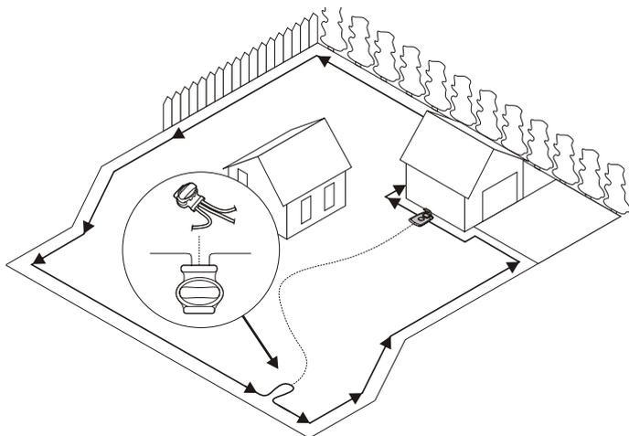
Sekačka používá volitelný vodící drát, aby našla cestu zpět do nabíjecí stanice, ale také k dosažení těžko přístupných oblastí v provozním prostoru. Vodící drát se například pokládá mezi nabíjecí stanicí a vzdálenou část pracovního prostoru nebo do úzkého průchodu.
