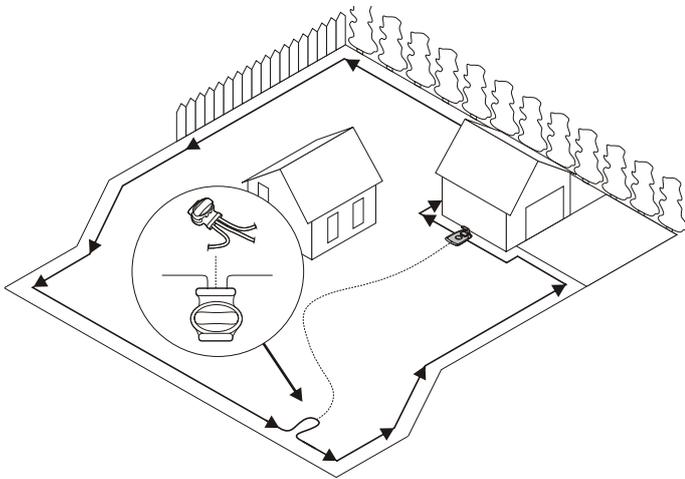
Robotul de tuns iarbă utilizează firul de ghidare opțional pentru a-și regăsi drumul înapoi la stația de încărcare, dar și pentru a accesa spații greu de accesat din zona de lucru. De exemplu, firul de ghidare este instalat între stația de încărcare și o porțiune îndepărtată din zona de lucru sau printr-un spațiu îngust.
