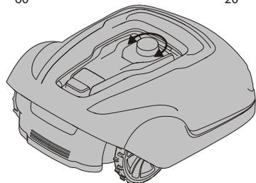
Aby nie dopuścić do przecięcia przewodu granicznego i przewodu prowadzącego, przez pierwszych kilka tygodni koszenia wysokość koszenia należy nastawić na 60 mm. Następnie ustawienie należy obniżyć o jedną pozycję tygodniowo, aż do uzyskania żądanej wysokości koszenia.
