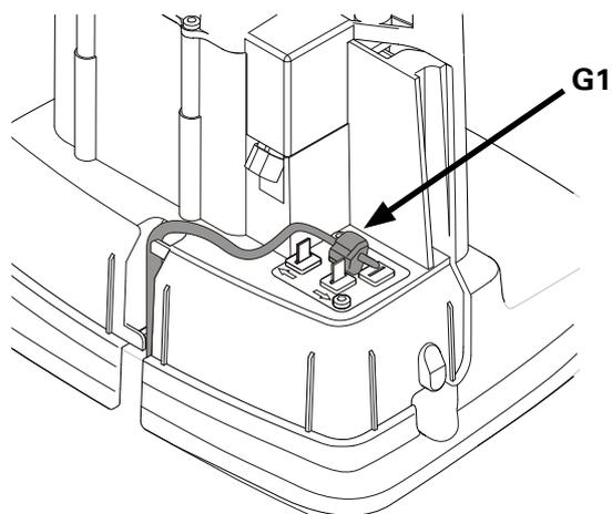
Inserire entrambe le estremità del cavo perimetrale e l'estremità del cavo guida nel connettore per giunti e cavi guida. Controllare che i cavi siano completamente inseriti nel connettore, in modo che le estremità siano visibili attraverso il connettore stesso.
