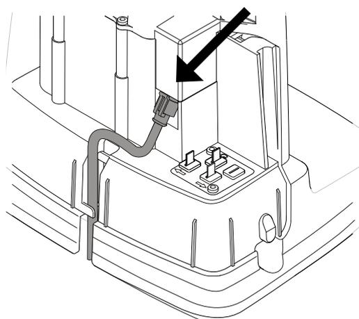
Podłączyć kabel niskonapięciowy do stacji ładowania.
