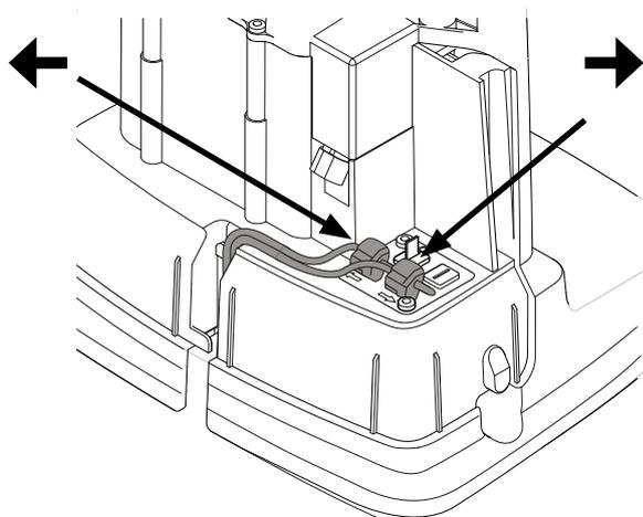
Připojte ohraničující drát k nabíjecí stanici, a to následujícím způsobem:
