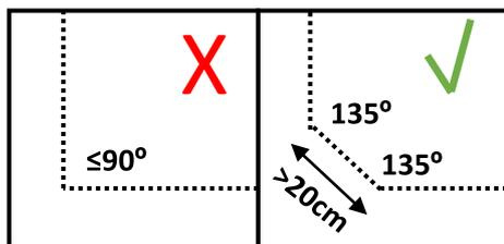
При прокладке кабеля, во избежание создания препятствий для перемещения газонокосилки, не допускайте поворотов провода под острым углом.
