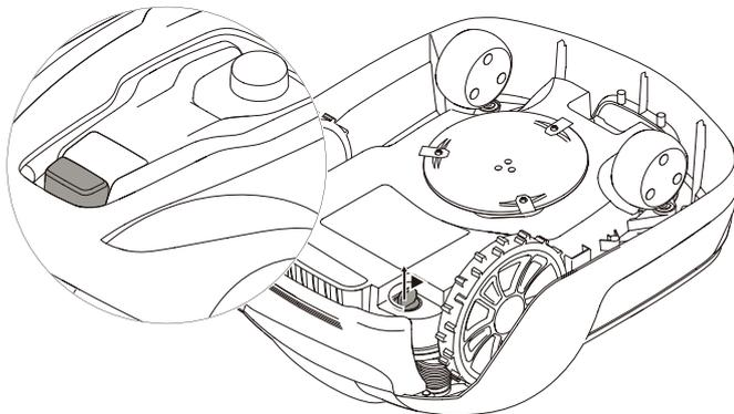
Na kosilnici pritisnite gumb **STOP** (USTAVI) in odstranite varnostni ključ.
