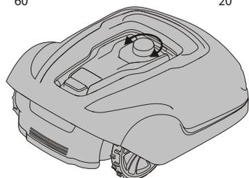
В течение нескольких первых недель эксплуатации высота скашивания травы должна составлять 60 мм, чтобы исключить контакта ножей с пограничным и направляющим проводами. Уменьшайте высоту скашивания травы каждую неделю, пока не будет достигнута желаемая высота скашивания.
