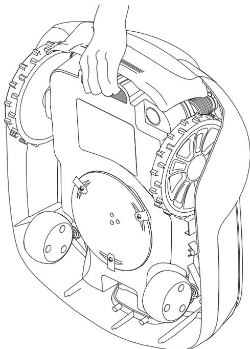
Pulse el botón de **PARADA** y retire la llave de seguridad antes de la elevación.
