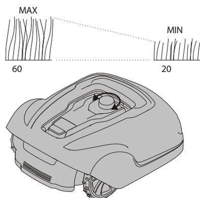
Per le prime settimane di utilizzo, impostare un'altezza di taglio pari a 60 mm per evitare di tagliare il cavo perimetrale e il cavo guida. Impostare un'altezza gradualmente inferiore ogni settimana fino a raggiungere l'altezza di taglio desiderata.
