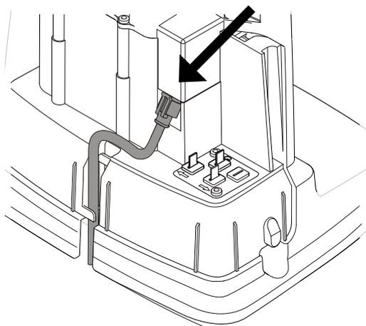
Conecte el cable de baja tensión a la estación de carga.
