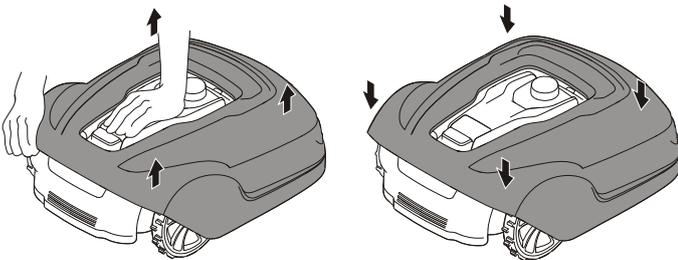
Hold plæneklipperen nede med den ene hånd, og løft med et fast tag et hjørne af kabinettet, og gentag for alle fire hjørner, indtil kabinettet løsner sig fra chassiset.
