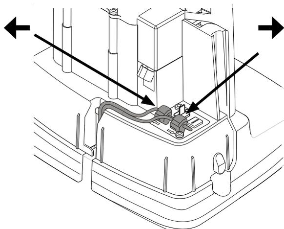
Conectați firul delimitator la stația de încărcare după cum urmează:
