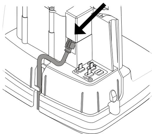
Zapojte nízkonapěťový kabel do nabíjecí stanice.
