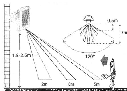
För optimal solexponering och längre funktionstid ska solcellspanelen placeras så att den står i direkt solstrålning i minst 8 timmar om dagen. Solcellspanelen ska helst riktas mot söder. Om solcellspanelen placeras i skugga kan batteriet inte laddas fullt och lampans funktionstid minskar. När du väljer plats för din solcellslampa med rörelsedetektor, se till att inte placera solcellspanelen nära nattbelysning såsom utelampor eller gatlyktor.
