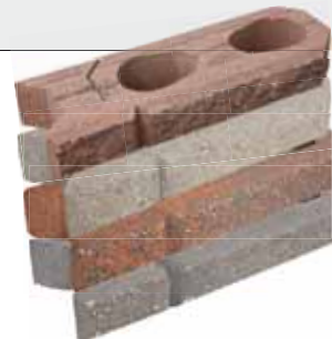
HB-Vallikivi ja HB-ISOvallikivi Kiviparin etenemä eli hyötötytius 580 mm. Vallikivivärit: harmaa, musta, punainen ja karelia=punamusta
