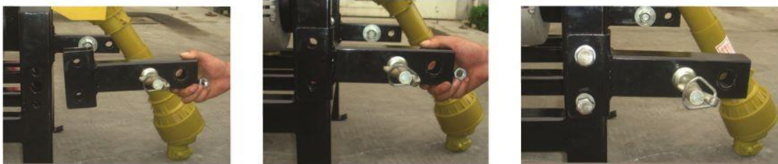
Kuva 3 – Liitäntäpaneelien asennus (valinnainen)
