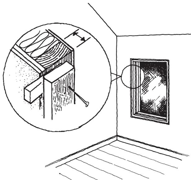
(SWE) Montera väggluckan i hålet genom att kila fast den med träkilar. Kontrollera att karmen är i vinkel samt att karmen sitter jäms med väggens insida.
