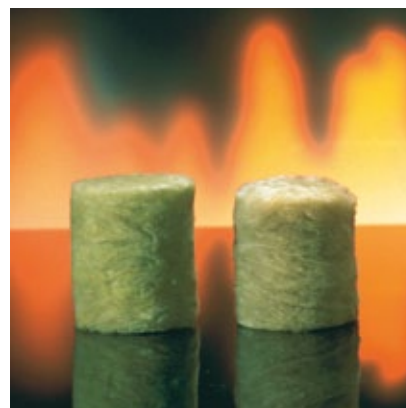
Vasemmalla on kivivillanäyte ennen palamattomuustestiä ja oikealla sama näyte testin jälkeen.
