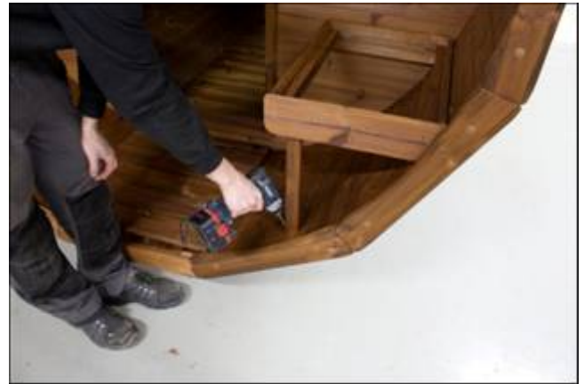
Asenna tukijalka. Tukijalat ruuvataan kiinni seinään ja istuimeen (45mm, puutappi 8x35). Alla olevasta kuvasta näkyy istuimet asennettuina.
