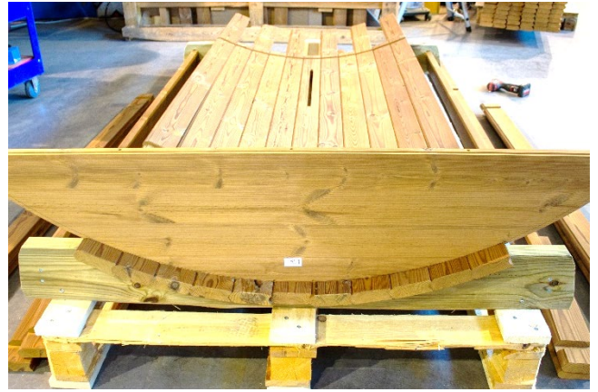
Tässä vaiheessa sijoitetaan ensimmäinen päätymoduuli (B1) takaosaan. Urosponntti ylöspäin! Katso kuva sivu 15.
