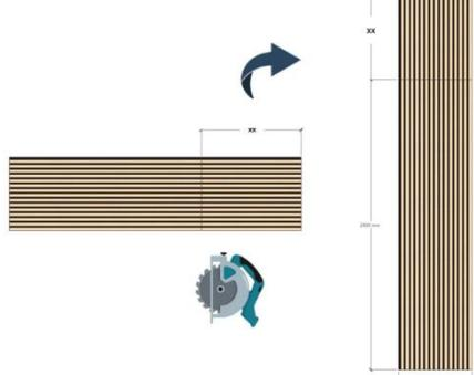
Vaihe 4. Seinämateriaalista riippuen, asenna tarvittaessa koolauspuut 60 cm välein. Asenna paneelit ruuvaamalla ne kiinni seinään 15 kpl ruuveja/paneeli rimojen väleistä. Kattoon asennettaessa ruuvien määrä 45 kpl/paneeli.
