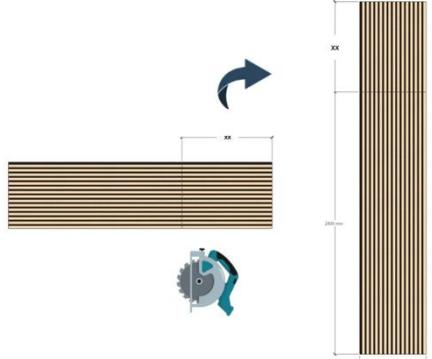
Steg 4. Beroende på väggmaterialet, montera vid behov lameller var 60 cm. Montera panelerna genom att skruva fast dem i väggen med 15 skruvar/panel mellan lamellerna. Vid montering i tak är antalet skruvar 45 st/panel.
