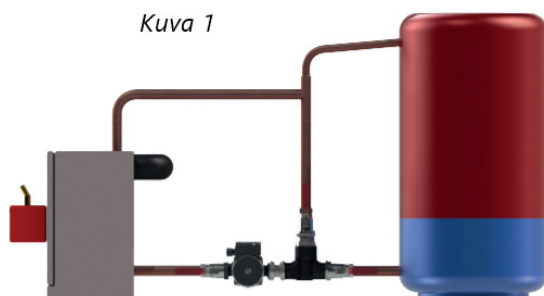
On suositeltavaa asentaa sulkuventtiilit Laddomat- ja pumppuhuollon helpottamiseksi.
