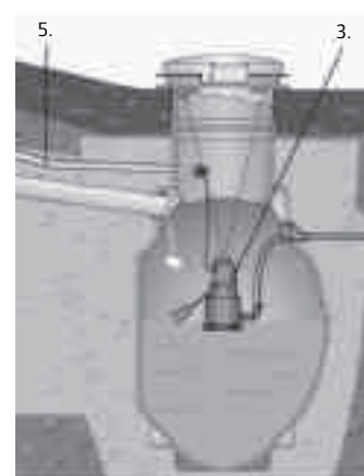
Uppopumppu asennettuna pumppukaivoon.
