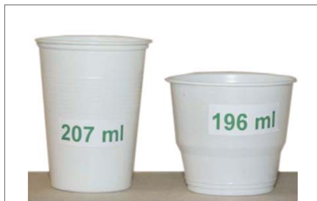
Kuva 5. Juotoslaastin notkeuden mittauskupit työmaalla
